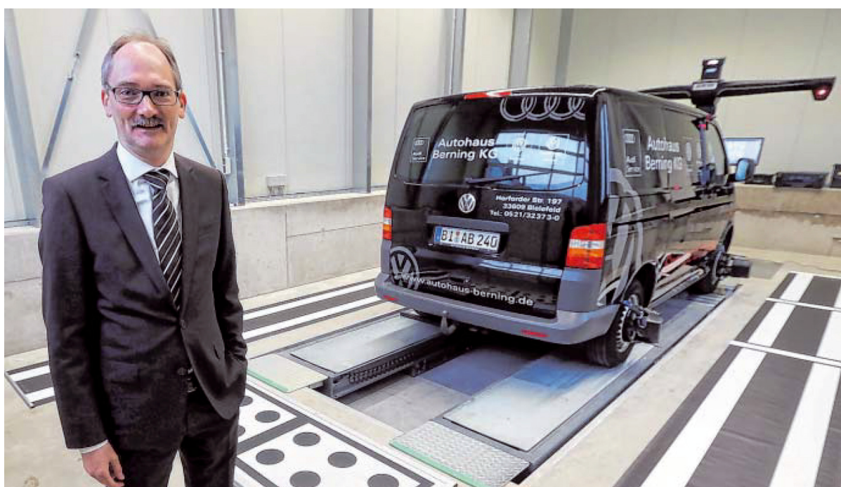
Neue Technik: Matthias Berning steht in der neuen Wartungshalle. Streifen und Punkte auf dem Boden dienen als Referenzmarken zum Einstellen von Rückfahrkameras oder Spurhalteassistenten.
